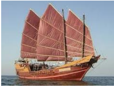
ジャンク(平底・隔壁構造)
