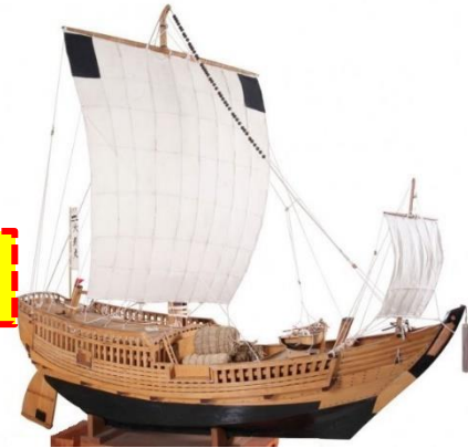
和船(平底・棚板構造)
